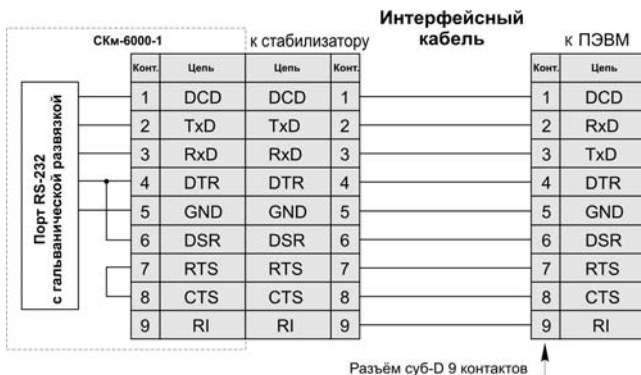
Рисунок 7 – Схема электрическая соединения стабилизатора с ПЭВМ
