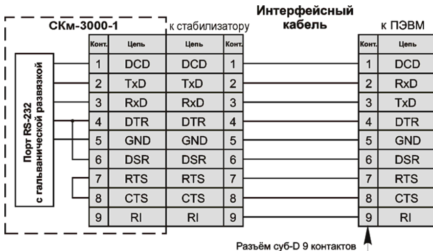
Рисунок 6 – Схема электрическая соединения стабилизатора с ПЭВМ
