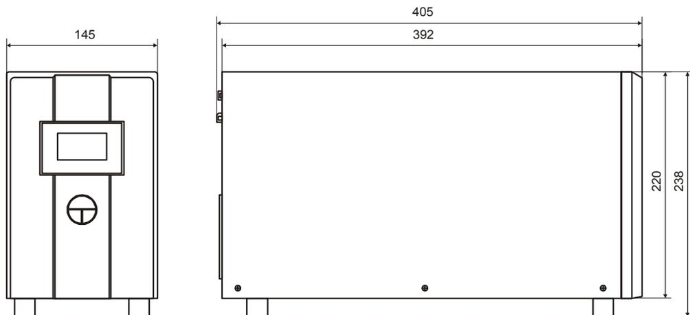
Рисунок А.1 – Габаритные и установочные размеры ИБП
