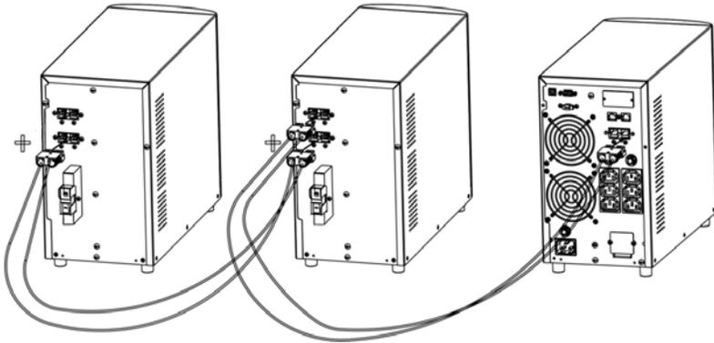
Рисунок 4 – Подключение нескольких БМ к ИБП
