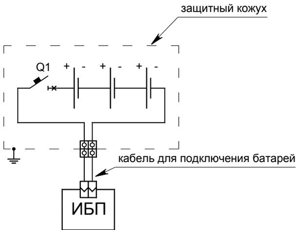
Q1 – автоматический выключатель S201 C50 «ABB» (рекомендуемый)
