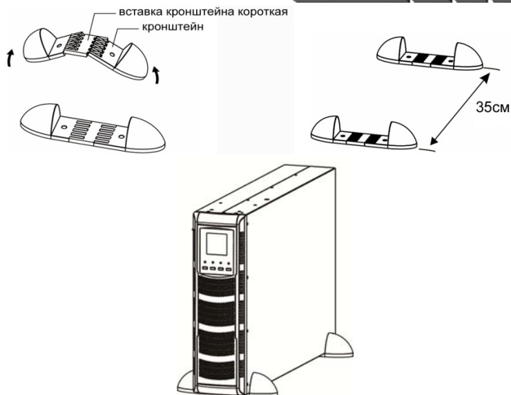
Рисунок 6 – Порядок установки ИБП в вертикальное напольное (настольное) положение
