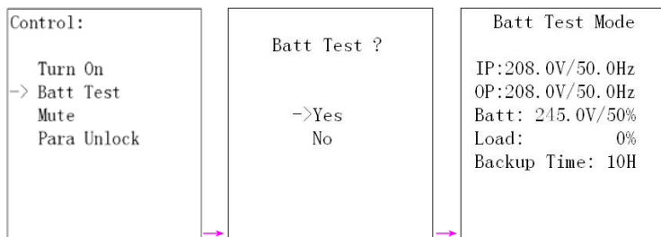
Рисунок 15 – Включение тестирования батареи ИБП
